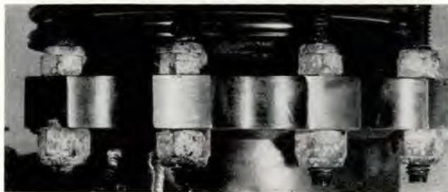
Fig. II. Dissimilar Metal Corrosion
