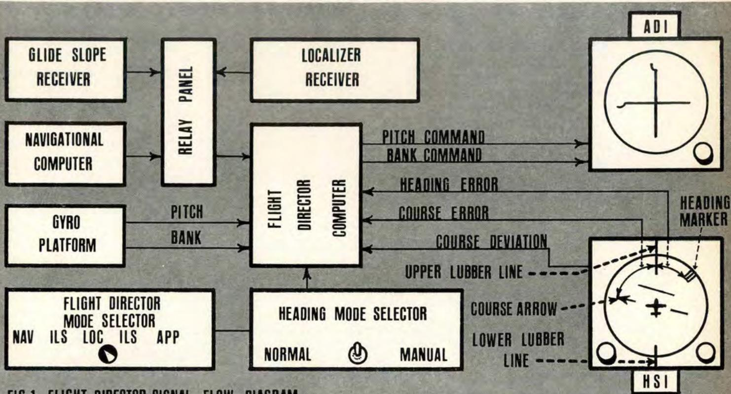
FIG 1. FLIGHT DIRECTOR SIGNAL FLOW DIAGRAM
